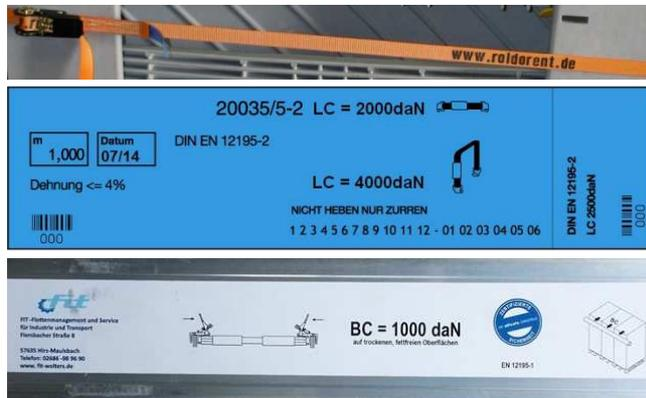
Das maximal zu sichernde Gewicht gegen die Fahrtrichtung entspricht der **Sicherungskraft des Hilfsmittels x 2.**
