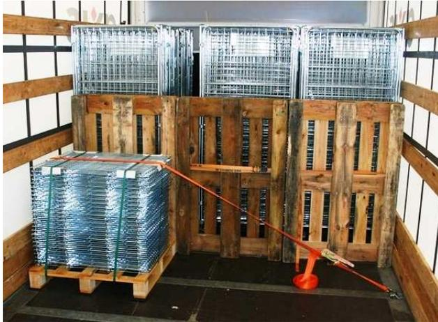
Zu den Sicherheitscontainern gehört eine Ladeinheit aus Einlegeböden auf Palette. Diese wird in Fahrtrichtung formschlüssig gegen die Paletten vor den Sicherheitscontainern gestaut.
