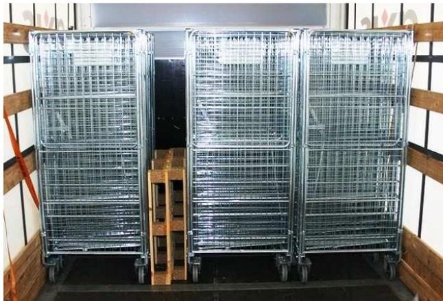
Vor dem Sichern mit der Kopfschlinge müssen vorhandene Staulücken z.B. mit Leerpaletten geschlossen werden.
