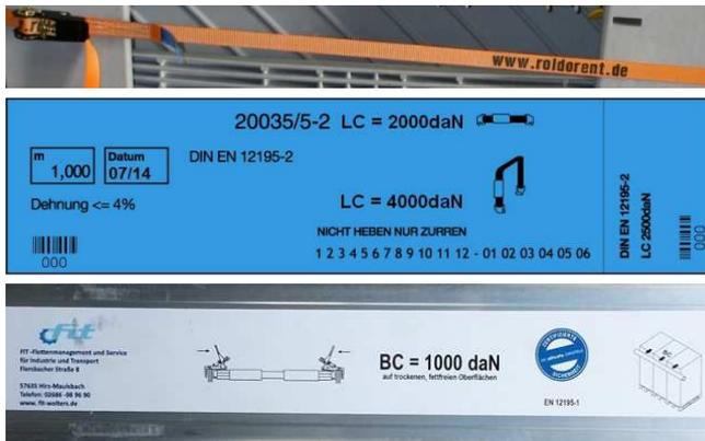
Das maximal zu sichernde Gewicht gegen die Fahrtrichtung entspricht der **Sicherungskraft des Hilfsmittels x 2.**
