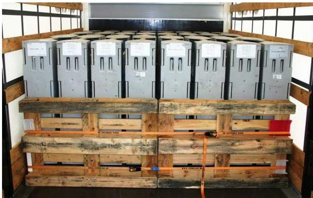
Ebenso verhindern Paletten ein Herunterrutschen des Gurtes. Diese haben den Vorteil, dass sie zusätzlich die Gurtkraft auf eine größere Fläche übertragen.
