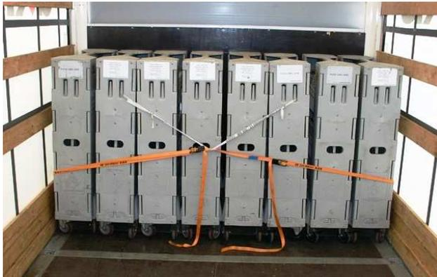
Dabei ist darauf zu achten, dass Formschluss zur Stirnwand und seitlich zum Fahrzeugaufbau hergestellt wird.
