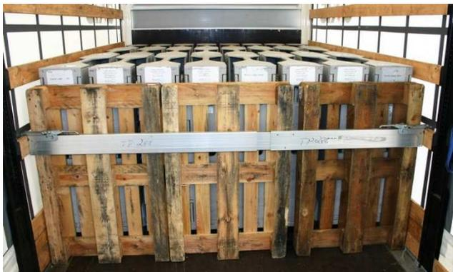
Um die Kraft des Zwischenwandverschlusses auf eine größere Fläche zu übertragen und evtl. Staulücken zu schließen, kann der Zwischenwandverschluss mit Paletten kombiniert werden.
