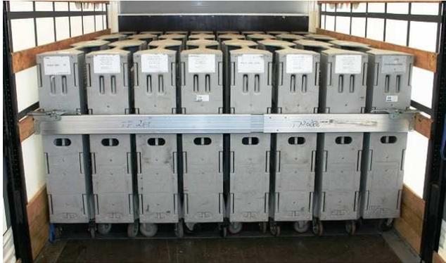
Ebenso kann die Sicherung gegen die Fahrtrichtung durch Verwendung eines Zwischenwandverschlusses (Klemmbrett) erfolgen.
